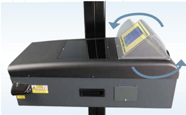
Pantalla giratoria para facilitar el ajuste del faro
