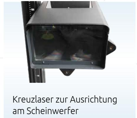
Kreuzlaser zur Ausrichtung am Scheinwerfer
